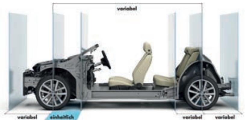
**MQB – der neue Modulare Querbaukasten**
